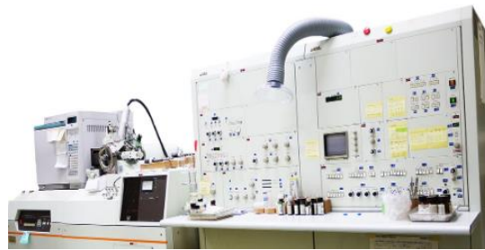
分析機器の一例：高分解能質量分析装置 MS (日本電子JMS-SX102A)
