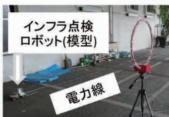
電力線通信時の不要電磁界測定
