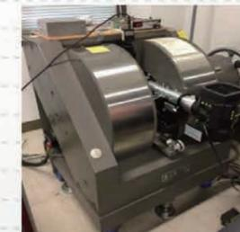
図1 磁気Kerr効果顕微鏡
